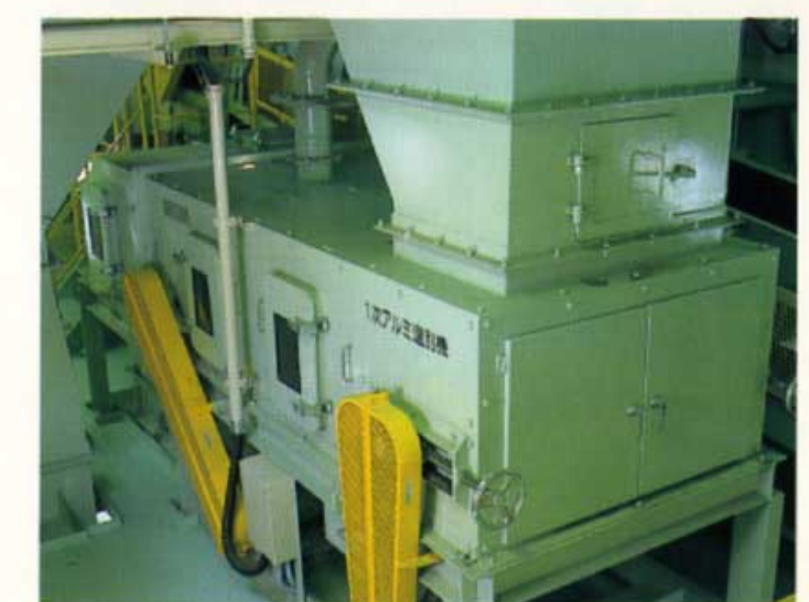
▲1次アルミ選別機 アルミと可燃物に選別します。
