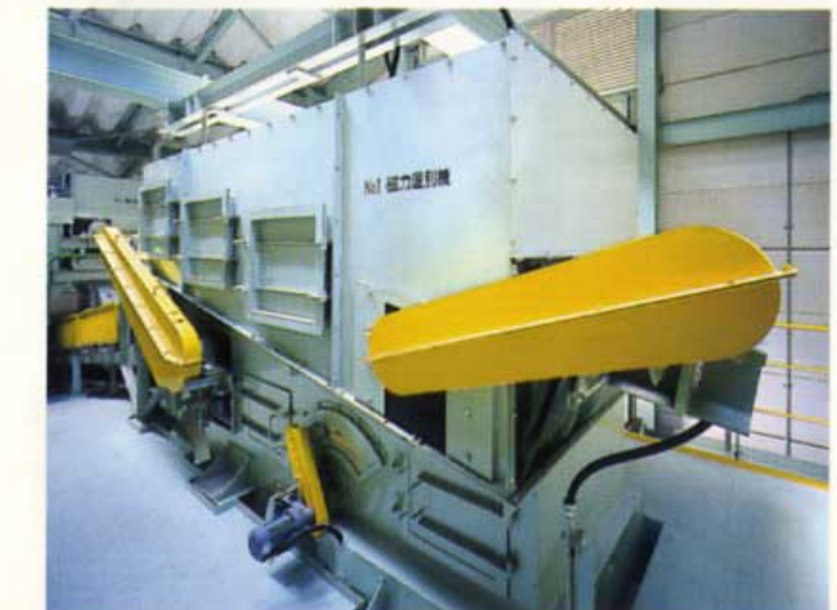
▲No.1 磁力選別機 鉄を磁力により回収します。
