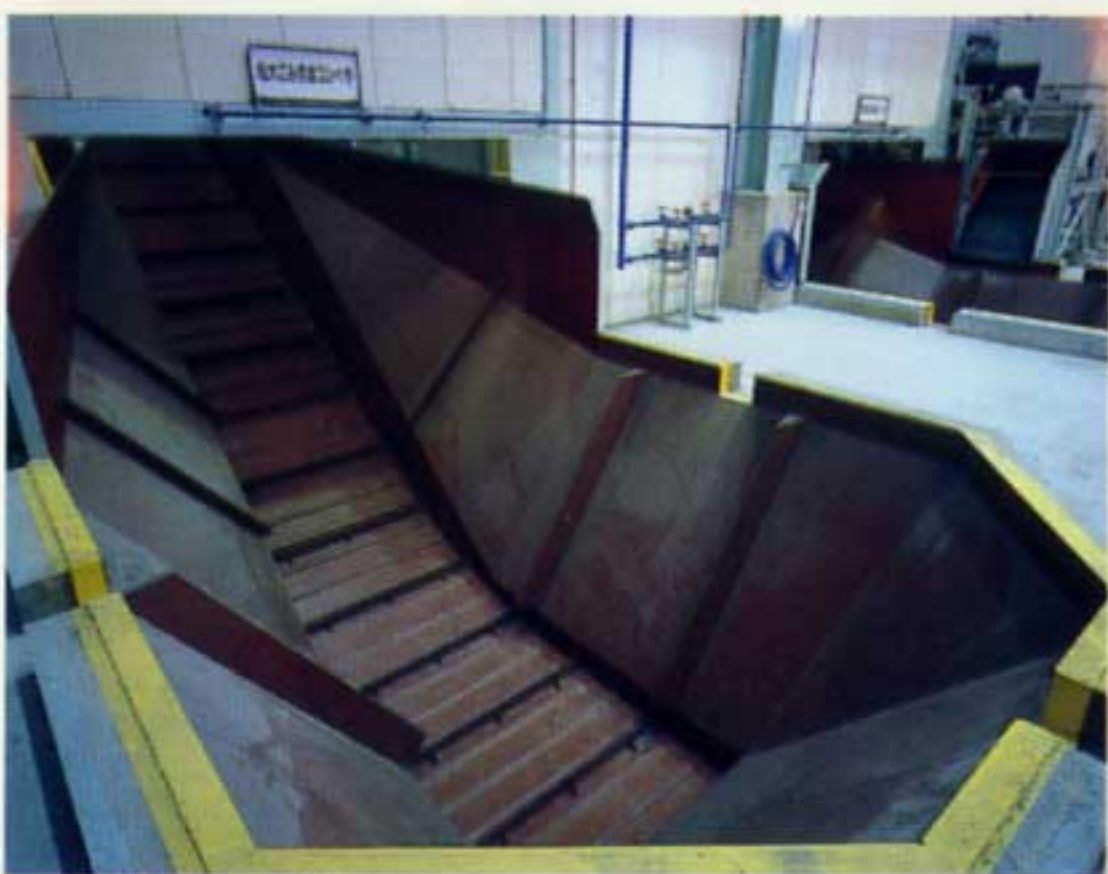
▲粗大ごみ供給コンベヤ 受入ホッパに投入されたごみを切断機に円滑かつ定量に供給します。
