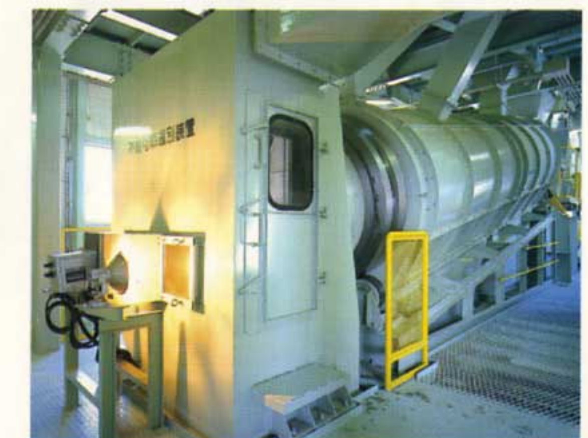
▲不燃可燃選別装置 不燃物(ガラス・陶器)、可燃物を選別します。
